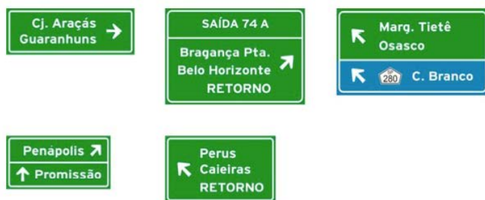
Placas de confirmação de sentido
